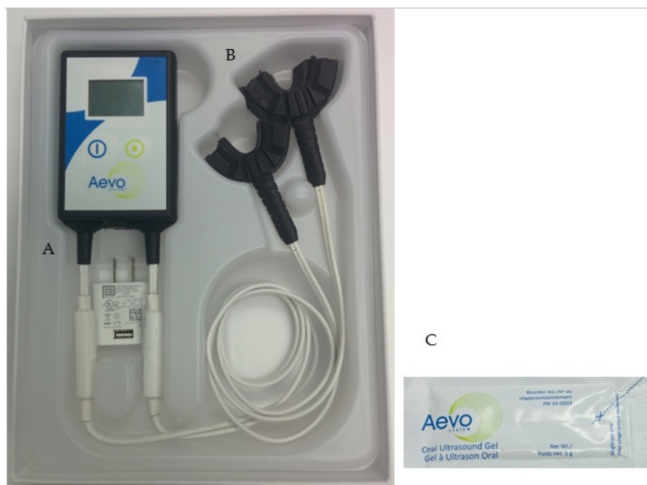
Figure 1. Appareil à ultrasons pulsés de faible intensité (LIPUS) (système Aevo). (A) : dispositif électronique portable ; (B) : embouts buccaux ; et (C) : gel de couplage ultrasonore.
